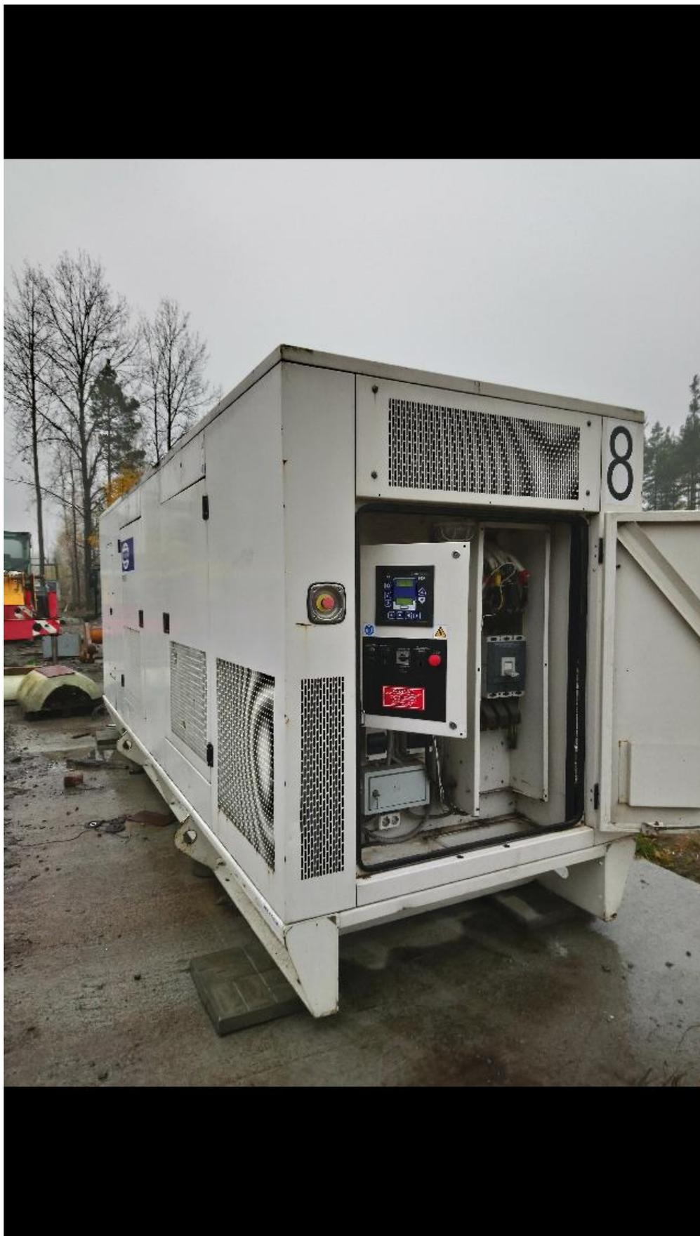
Продается ДГУ Р500РЗ 380-415В, 50 Гц с двигателями Perkins 2806С-Е16TAG2 , частота вращения двигателя 1500 об/мин в кожухе на прочной стальной раме.
